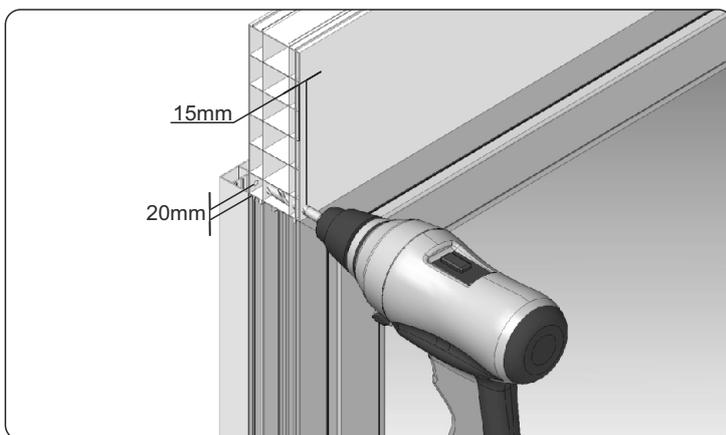
6. Percer un trou pour passer le cordon avec un foret de 12mm à distance de 20mm à partir du bord inférieur de l'élargisseur et ensuite les serrer.
