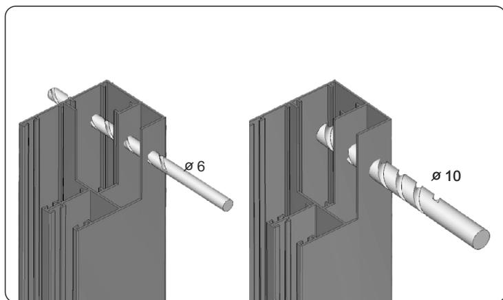
1. Percer des orifices dans les coulisses. Utiliser un foret de 6mm pour réaliser un orifice dans les deux chambres de la coulisse et un foret de 10mm pour agrandir l'orifice uniquement dans la première chambre du côté extérieure de la coulisse.
