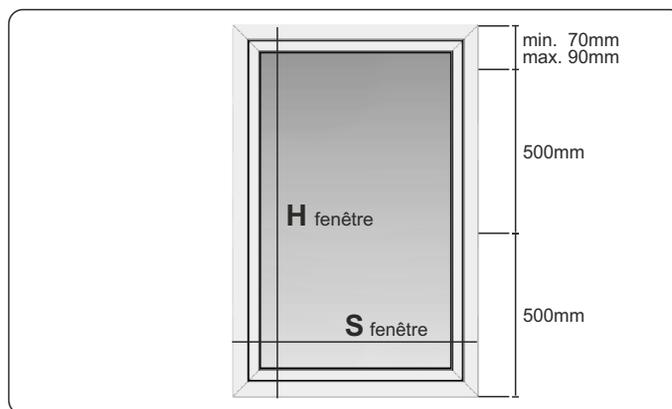
2. Pour obtenir la hauteur totale du volet roulant, ajouter la hauteur du coffre à la hauteur réelle de la fenêtre. La largeur de la fenêtre constitue la largeur totale du volet roulant. Mesurer et marquer sur les coulisses les trous à percer pour les vis de montage. Percer le premier trou à distance de 90 mm max. à partir du bord supérieur de la coulisse et les autres à distance de 500mm max. Le perçage des trous peut être réalisé par la société PORTOS sur une simple demande du client..
