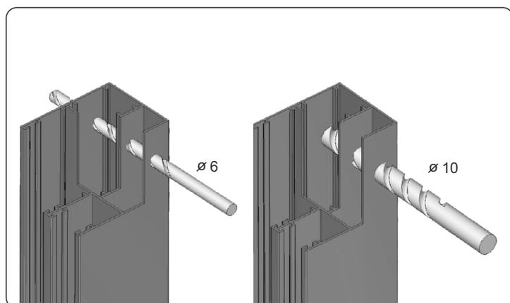
3. Percer des orifices dans les coulisses. Utiliser un foret de 6 mm pour réaliser un orifice dans les deux parois de la coulisse et un foret de 10mm pour agrandir l'orifice uniquement dans la première paroi du côté extérieure de la coulisse.
