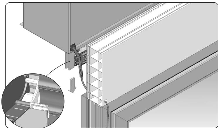
7. Poser le coffre sur les coulisses fixés sans oublier de faire passer le cordon et le ressort par le trou préalablement réalisé tout en ajustant la longueur du ressort à la largeur de l'élargisseur. Insérer soigneusement la baquette inférieure de manière à ne pas endommager la toile de moustiquaire.
