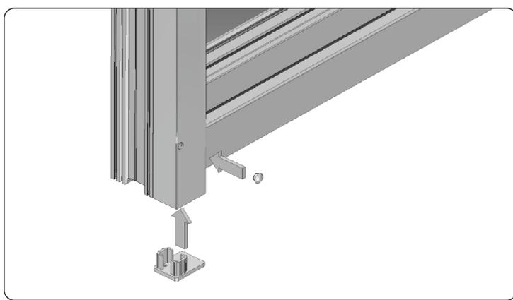
6. Serrer les vis dans les coulisses et insérer les bouchons de masquage, et si besoin, les bouchons inférieurs des coulisses.
