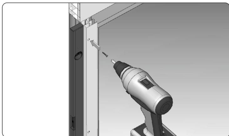
5. Ajuster les coulisses en utilisant le niveau et visser-les.
