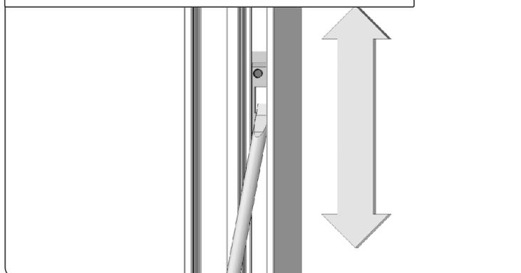
12. La hauteur de la fermeture de la moustiquaire peut être ajustée en déplaçant les attaches qui se trouvent dans la partie inférieure des coulisses.
