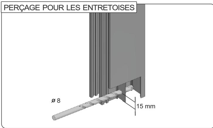
2. En cas de montage des volets roulants avec des entretoises automatiques, percer la partie centrale de la coulisse en utilisant le foret de 8 mm à distance de 15 mm du bord inférieur.
