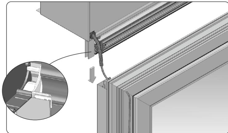
8. Poser le coffre sur les coulisses fixés sans oublier de faire passer le cordon et le ressort par le trou préalablement réalisé tout en ajustant la longueur du ressort à la largeur du châssis de fenêtre. Insérer soigneusement la baquette inférieure de manière à ne pas endommager la toile de moustiquaire.
