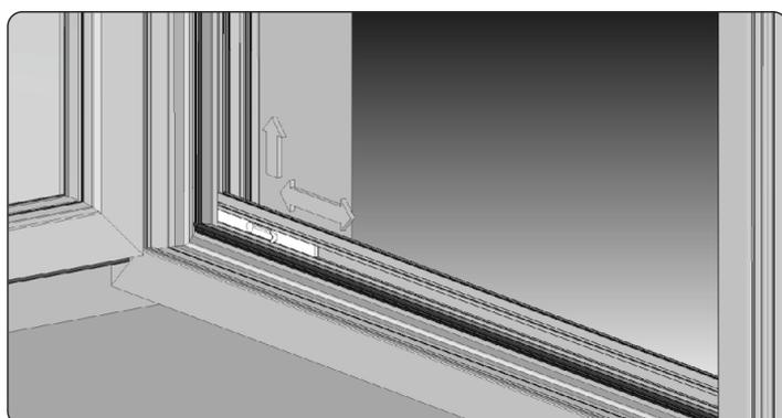
Après le montage et le réglage effectué correctement, la mousquetaire doit fonctionner de manière fluide sans froisser la toile.
