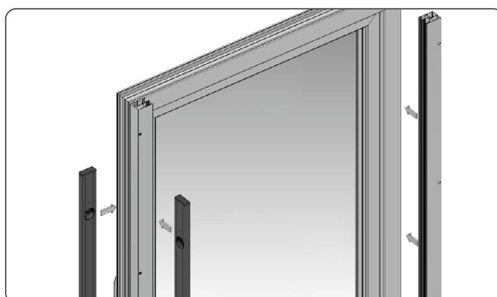
4. Positionner et ajuster les coulisses percées contre le cadre de la fenêtre en utilisant un niveau.
