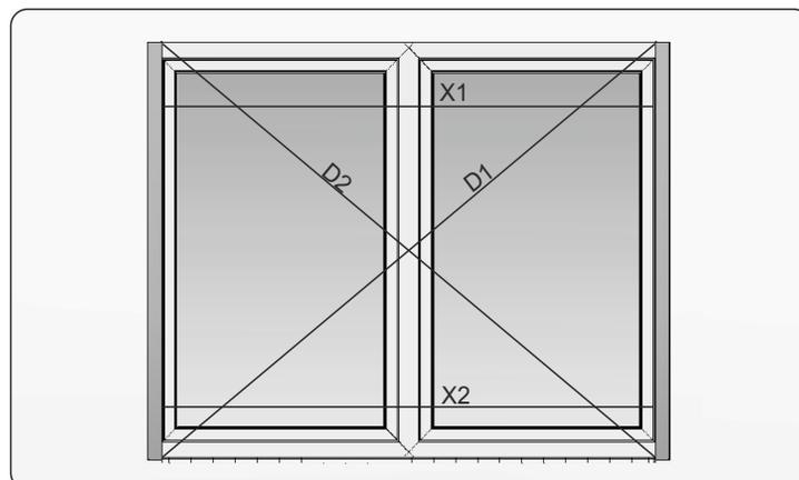
6. Mesurer X1 et X2 de la coulisse inférieure et supérieure ainsi que les deux diagonales D1 et D2. La différence entre les dimensions de X1 et X2 ainsi que de D1 et D2 ne doit pas être supérieure à 2mm.
