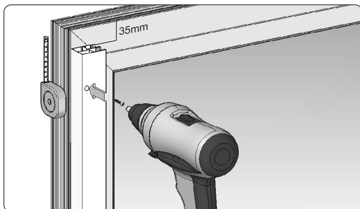
5. Visser la coulisse à distance de 35mm au-dessous du bord supérieur du châssis de fenêtre.
