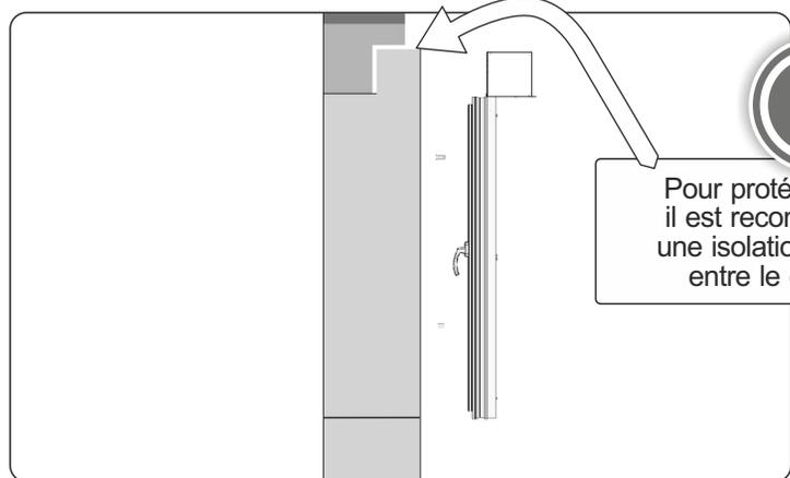
! Pour protéger contre le gel, il est recommandé d'utiliser une isolation supplémentaire entre le coffre et le mur
