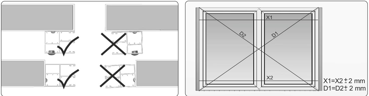
Le réglage incorrect des attaches dans les coulisses du mousquetaire peut avoir un impact sur le fonctionnement des attaches (p.ex. lorsqu'un seul côté de la lame inférieure du mousquetaire s'accroche à l'attache).
