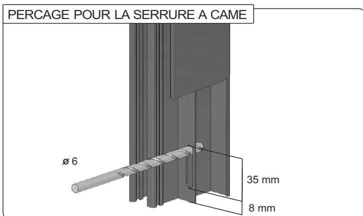
4. En cas de montage du volet roulant avec serrure à came, percer un trou de 35 mm de longueur dans la partie centrale de la coulisse en utilisant le foret de 6 mm à distance de 8 mm du bord inférieur.
