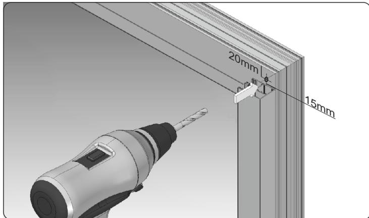
7. Percer dans le châssis de fenêtre un trou de 12mm à distance de 20mm à partir du bord supérieur du châssis de cadre.
