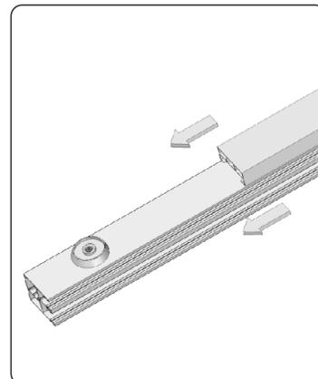
14. Fixer les cliquets en utilisant des vis incluses dans le kit et ensuite faire glisser la baguette de distance dans la coulisse.
