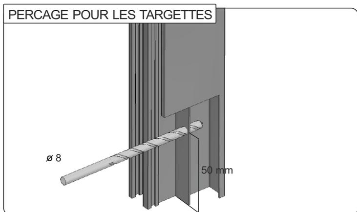
3. En cas de montage du volet avec des verrous, percer la partie centrale de la coulisse en utilisant le foret de 8 mm à distance de 50 mm du bord inférieur.
