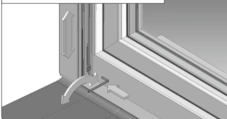
Après avoir desserré les vis à l'aide de la clé Allen de 2 mm, déplacer les attaches vers le bas ou vers le haut en utilisant le tournevis. En cas du système CLIC-CLAC, desserrez la vis en utilisant la clé Allen de 3mm et réglez à la hauteur désirée.
