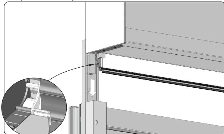
17. Faire glisser soigneusement le coffre sur la coulisse, tout en insérant les tiges sur les côtés dans la partie supérieure des coulisses. Installer la lame inférieure de manière à ne pas endommager la toile de la moustiquaire.
