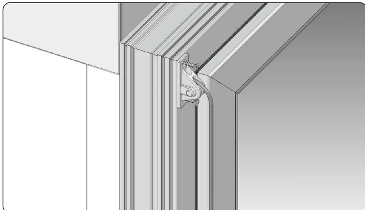
9. Faites passer le cordon par la coulisse et ensuite vissez-la au châssis de fenêtre.
