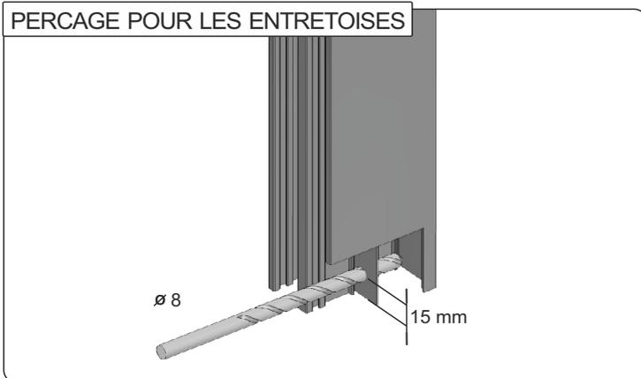
2. En cas de montage des volets roulants avec des entretoises automatiques, percer la partie centrale de la coulisse en utilisant le foret de 8 mm à distance de 15 mm du bord inférieur.
