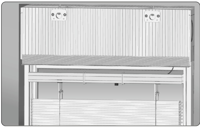
9. Włożyć pakiet z żaluzją fasadową w skrzynkę w uchwyty szyny górnej.
