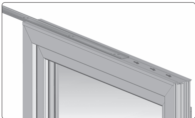
W przypadku użycia adaptera nasuwanego na ramę nałożyć adapter PVC, a następnie wsunąć część aluminiową tego adaptera zachowując 1 cm przerwy po bokach.
