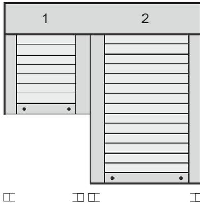
Im obigen Beispiel können die Antriebe von beiden Rollladen links oder rechts untergebracht werden.
