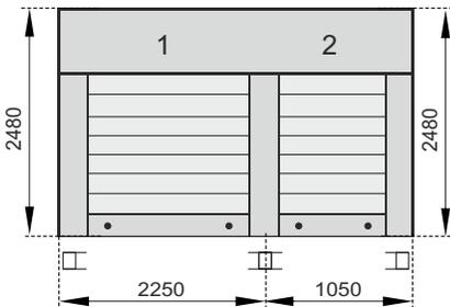
Set: zwei Rollläden (Ansicht von innen). Beim Bestellen der Aufträge von Rollläden wird ein Grundsatz angenommen, dass auf der Vorlage Rollläden in der Reihenfolge von links nach rechts, von innen des Raumes eingetragen werden. Die beiden Rollläden sind 248 cm hoch.
