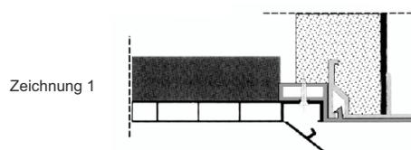
Die Montage der Revisionsklappe am Fensterrahmen erfolgt mit Hilfe von einem Abrollprofil (siehe Preisliste der Rollläden im Sturz - Rollladen - System) oder Montageprofilen (bei allen Fensterprofilherstellern). Um die Länge des Abrollprofils zu messen, muss man von der Fensterbreite die doppelte Breite der Führungsschiene abziehen
