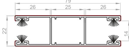
DOPPELTE ALU-FÜHRUNGSSCHIENE **PPDW-105**
