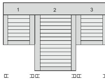
Im obigen Beispiel können die Antriebe in allen Rollladen (1,2,3) links oder rechts untergebracht werden.
