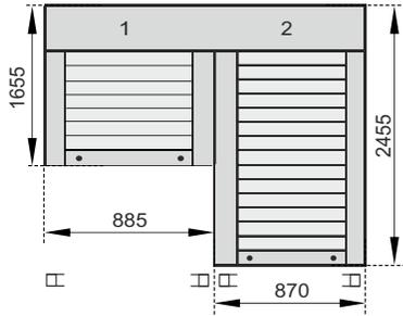
Set: zwei Rollläden (Ansicht von innen). Beim Bestellen der Aufträge von Rollläden wird ein Grundsatz angenommen, dass auf der Vorlage Rollläden in der Reihenfolge von links nach rechts, von innen des Raumes eingetragen werden. Der erste Rollläden ist 165,5 cm und der zweite 245,5 cm hoch.
