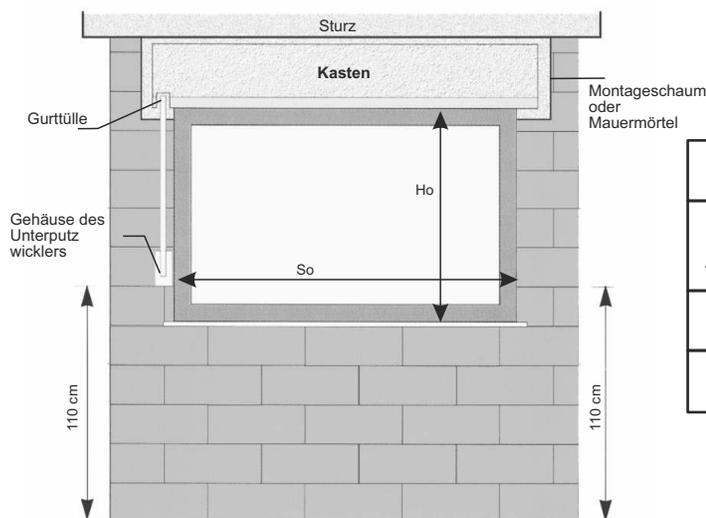
Die Fensteröffnung muss für die Montage eines Sturz - Rollladens in Form eines unförmigen „T“ Buchstabes vorbereitet werden.
