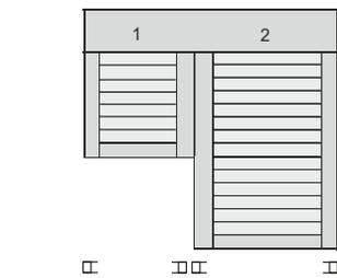
Im obigen Beispiel können die Antriebe von beiden Rollladen links oder rechts untergebracht werden.
